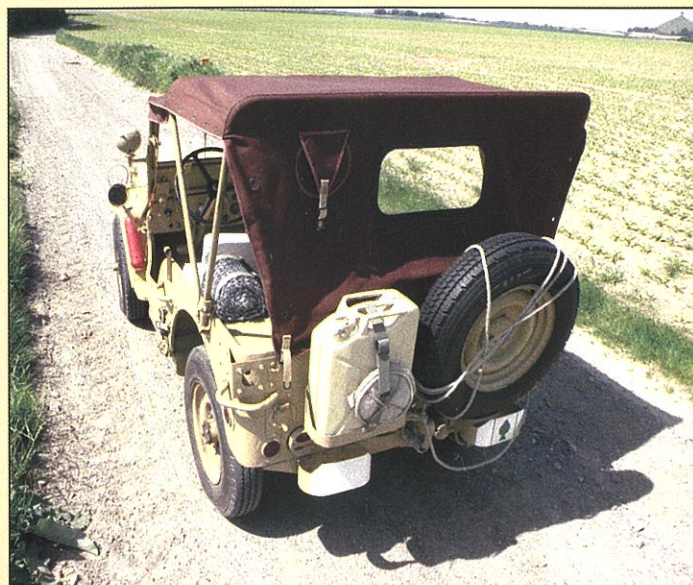
Détail de la bâche « Sahara » de couleur brune qui équipait les Jeep dans le désert. Elle ne protège pas de la pluie, mais du soleil. Ce ne fut pas le seul type de capote utilisée puisque de nombreuses photos montrent également des bâches beiges sans mica à l'arrière.
