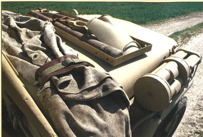
Le préfiltre à air Técalémit BE.505 avec sa plaque d'identification ainsi que le rack de Dodge vissé sur le capot, l'emplacement original de la pelle et de la hache étant occupé par un jerrycan de 10 litres.
